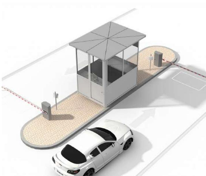
Esta solución provee al usuario un acceso rápido sin necesidad de tarjetas, sacar la mano por la ventana, y según la aplicación puede incluso no necesitar detenerse. El sistema consiste de una terminal U1000/U2000, tags UHF (según el tipo de tag, instalado en el cristal, portaplacas o tarjeta) y una barrera vehicular.
