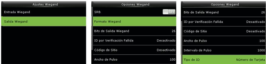
Seleccione “Salida Wiegand” para ajustar los parámetros en la interfaz de Salida Wiegand.
