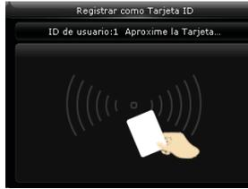
Coloque la tarjeta en el área de tarjeta hasta que la operación sea exitosa.
