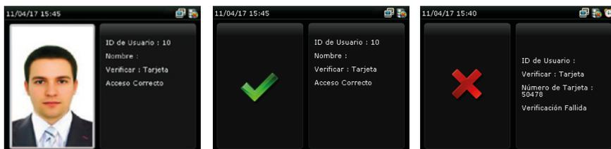
En los dispositivos con la función ID con Foto, la figura 4 se mostrará en la pantalla después de una verificación exitosa, de no contar con la función, se mostrará la figura 5.
