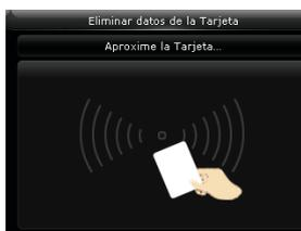
Coloque la tarjeta Mifare en el área de tarjeta, espere a que el dispositivo elimine todos los datos en la tarjeta.
