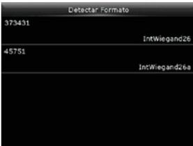
2. Elija el elemento que corresponda al número real de la tarjeta y establézcalo como el **Formato Wiegand** del dispositivo. Este es el formato necesario para leer el tipo de tarjeta presentada.
