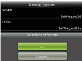
**Observaciones:** En la interfaz de Detección Automática de Formato de Tarjeta de un dispositivo IC, el dispositivo no puede detectar el número de la tarjeta o el formato wiegand solamente deslizando una Tarjeta ID. Para detectar el formato wiegand de una Tarjeta ID, es necesario conectar un lector de tarjetas IC al dispositivo y deslizar la tarjeta en el lector auxiliar.
