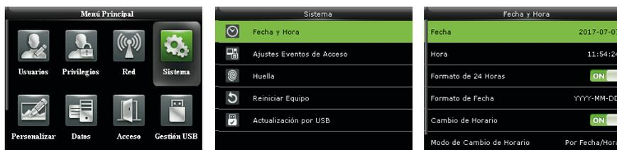
En la interfaz inicial, pulse **>** **Sistema** > **Fecha y Hora** para entrar en la interfaz de configuración de la fecha / hora. Se incluye el establecimiento de la fecha, hora, reloj de 24 horas, formato de fecha y el horario de verano. Al restablecer la configuración de fábrica, el formato de fecha puede ser restaurado (AAAA-MM-DD).
