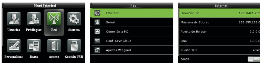
En la interfaz inicial, presione
