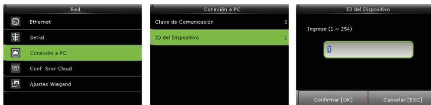
En la interfaz inicial, presione  $\rightarrow$  > **Red** > **Conexión a PC** > **ID del Dispositivo**
