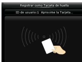
Coloque la tarjeta Mifare en el área de tarjeta, espere a que el dispositivo lea los datos de la huella y retire la tarjeta hasta que la operación sea exitosa.
