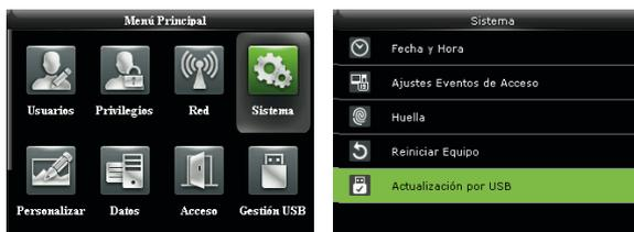
Inserte la Unidad USB con el archivo de actualización en el puerto USB del dispositivo, y en la interfaz inicial presione > **Sistema** > **Actualización por USB** para completar la operación de actualización de firmware.
