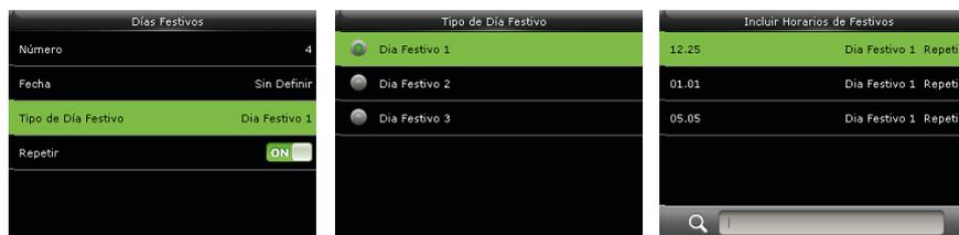
**Repetir:** El valor predeterminado de “Repetir” es Encendido **[ON]**. Puede presionar ↵ para cambiar entre Encendido **[ON]** y Apagado **[OFF]**.
